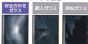
ショットバックによる破壊
